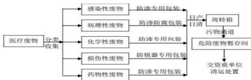
图 4-2 医疗废物处理工艺流程
