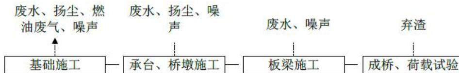
图 3.1-1 桥梁施工工艺流程及产污环节示意图
