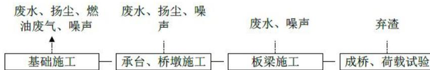
图 2.13-1 桥梁施工工艺流程及产污环节示意图
