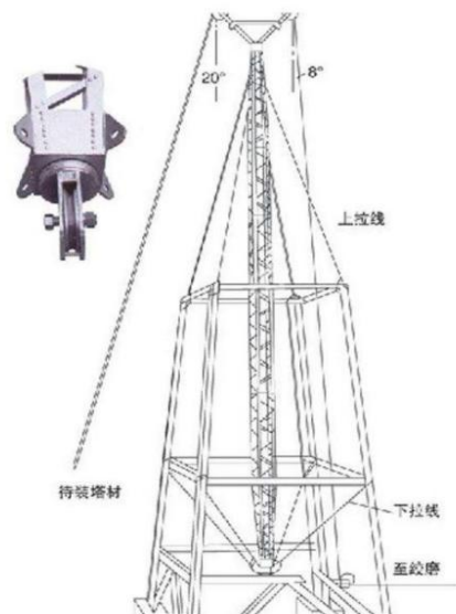
图 5-8 采用先进的内拉线悬浮抱杆分解组塔示意图
