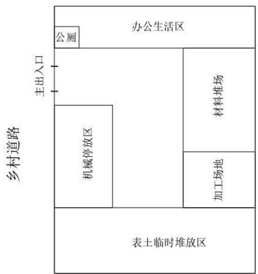
施工集中场地布置示意图
