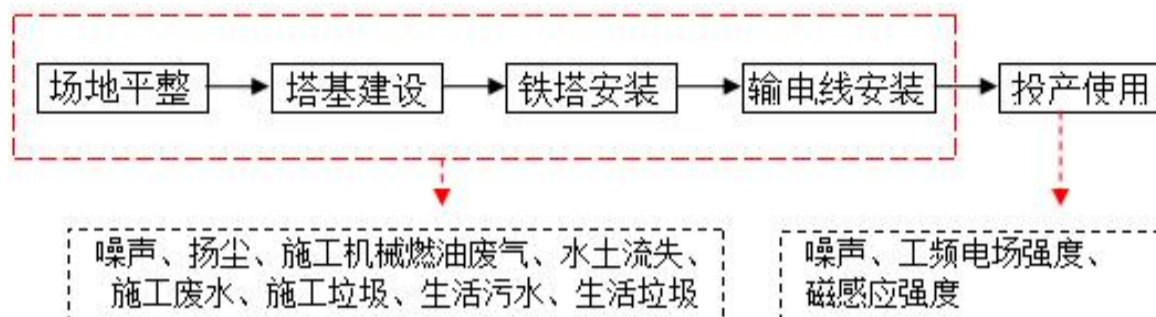
图 4.1.1 架空线路施工流程及产污节点示意图
