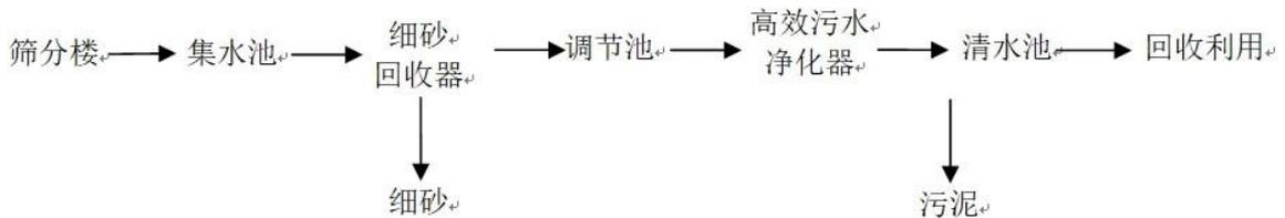
图 6.2.1-2 高效污水净化法处理流程图
